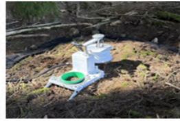
2 chambres de respiration automatisées LiCor CPJ Julien Crétat 15 k€
