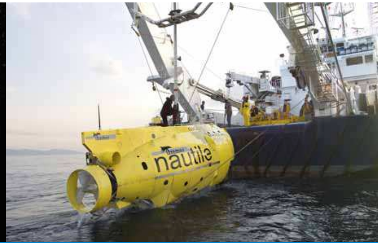
Le sous-marin français Nautilie et son navire support Aialante . Le Nautilie peut descendre jusqu'à 6 000 mètres en embarquant deux navigateurs et un scientifique qui peut ainsi réaliser observations, prélèvements et expériences sur des sites profonds.
