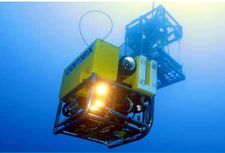
Minirobot Super Achille de la Comex équipé de caméras et d'un bras de manipulation.
