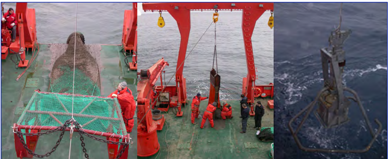
Figure 1.4b. Quelques outils d'échantillonnage. De gauche à droite : chalut Agassiz, drague à roche et carottier boîte (mission BENTART'06).
