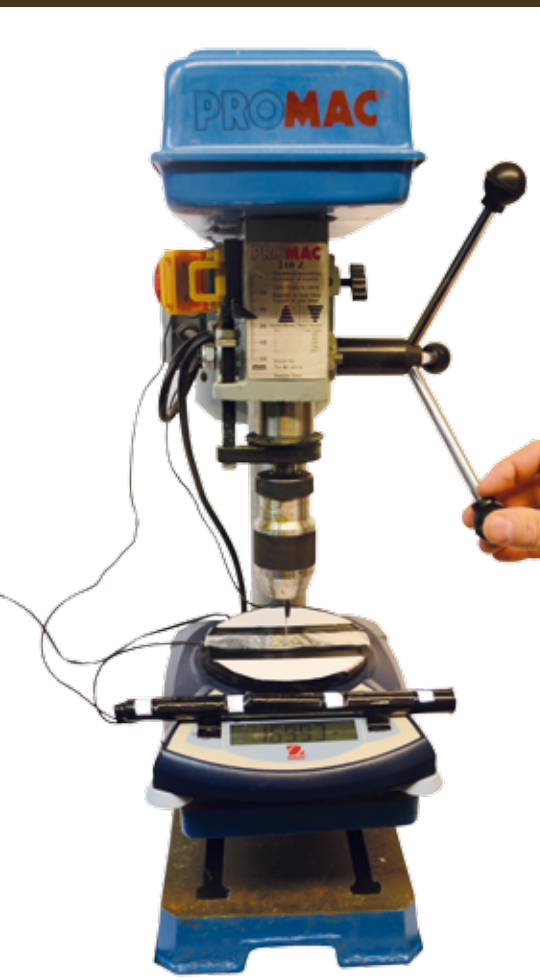
Construction de l'ovipositor à l'aide d'une perceuse à colonne et d'un circuit électrique (cliché C. Laubu).
