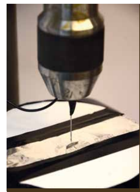
la perceuse à colonne munie d'une aiguille permet de standardiser la pique. L'enregistrement vidéo permet de retrouver l'instant exact où l'aiguille touche l'aluminium. On déduit du poids affiché la force de pénétration nécessaire à percer la cuticule (cliché C. Laubu).
