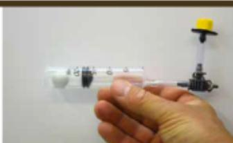
L'embout de la seringue est relié au tube tandis que le piston se situe au-dessus de l'aquarium. Des gicleurs à eau pour l'arrosage automatique sont utilisés et ont été transformés en soupapes permettant d'extraire l'air sous pression du système après l'expérience afin de réarmer les pistons (cliché C. Laubu).
